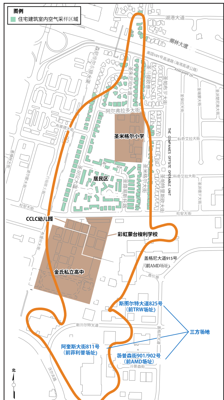
图二：室内空气采样区。约计浅层地下水（10英尺左右）TCE浓度超过标准值每公升5微克（µg/L）的范围。
