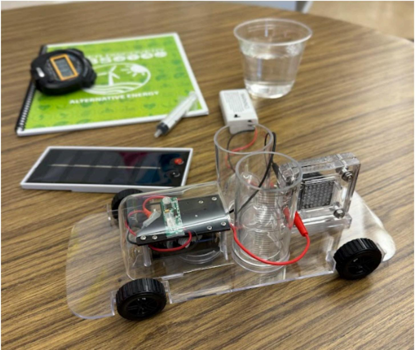
*"Las pilas de combustible de hidrógeno pueden producir electricidad de forma continua siempre que se les suministre hidrógeno y oxígeno, y el único SUBPRODUCTO (resultado) es agua. Estas propiedades de las pilas de combustible significan que son excelentes como fuentes de energía de respaldo en situaciones de emergencia, para alimentar pequeños vehículos industriales como carretillas elevadoras o para proporcionar energía y agua limpia para las misiones espaciales de la NASA".*
