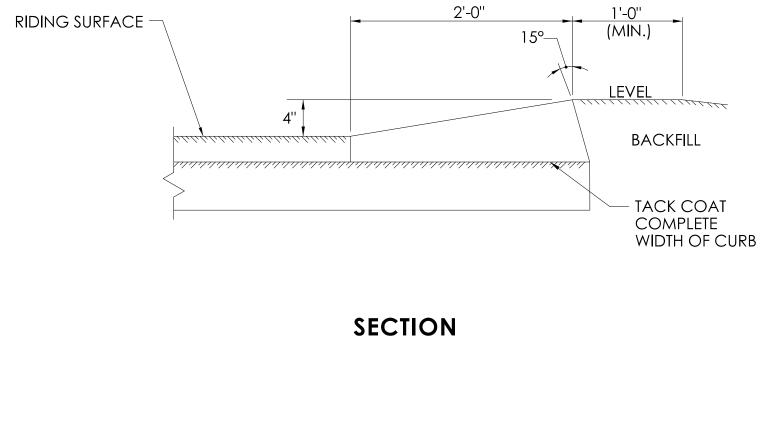
**BITUMINOUS CONCRETE CURBING**
