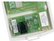
**Figure 28. Wall mtd display sensor
