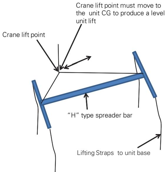
**Figure 35. CGAM slant 20-35 ton rigging**
