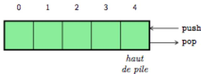
Figure 3.2 – Illustration d'une pile.
